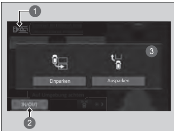
1 Schalter des Parkassistenten Honda Parking Pilot
